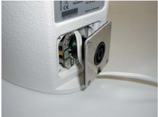
4. Lautsprecheranschlusskabel durch die untere Kabelauslasseinfräsung führen und Anschlussklemme wieder in das Lautsprechergehäuse einsetzen.
