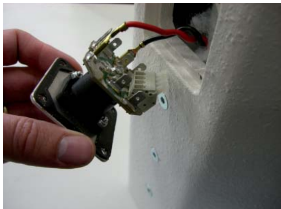
2. Duale Anschlussklemme vorsichtig herausziehen
